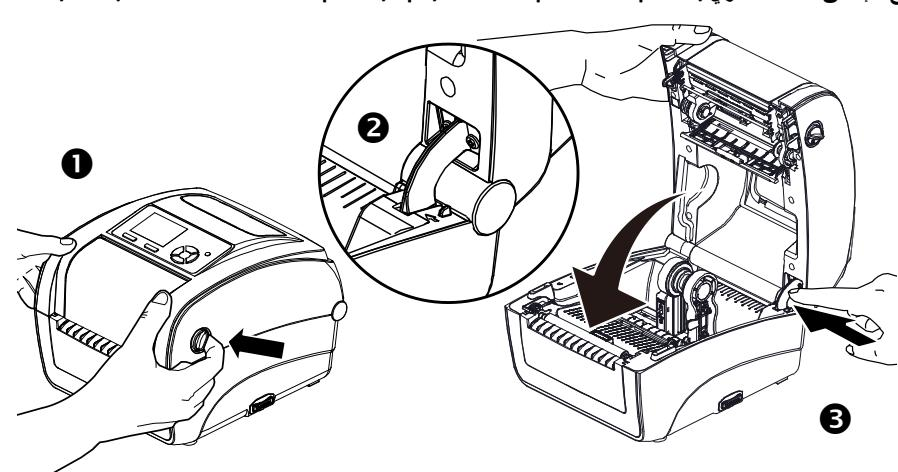
Loading Ribbon/安装碳带/安装碳带/ローディングリボン/Загрузочная лента/
