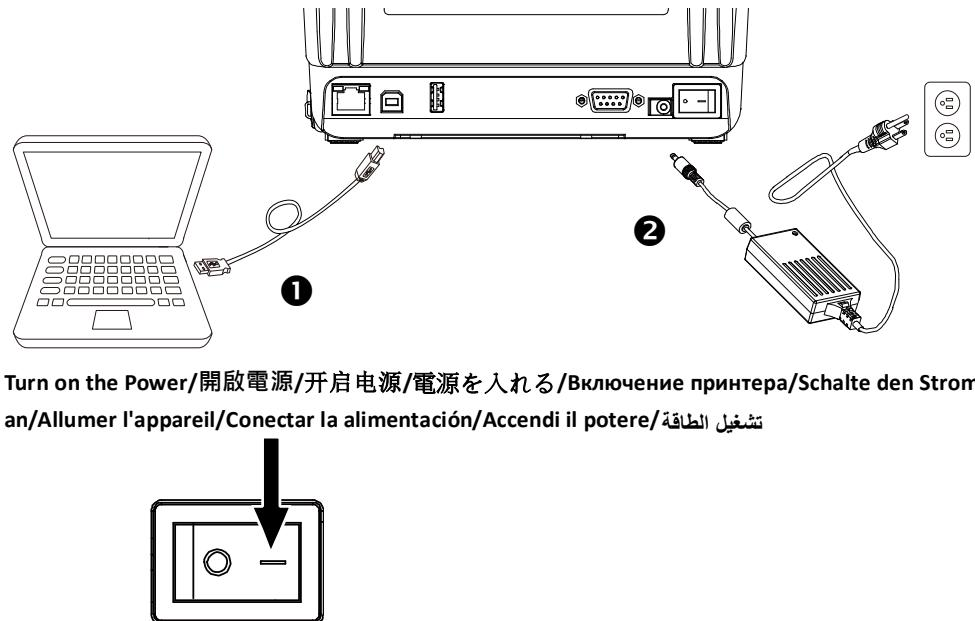
Turn on the Power/開啟電源/开启电源/電源を入れる/Включение принтера/Schalte den Strom an/Allumer l'appareil/Conectar la alimentación/Accendi il potere/تنشيف الطاقة/تنشيف الطاقة
